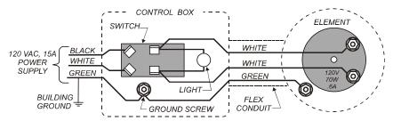
Fig. 2 H-006UL Wiring Diagram
